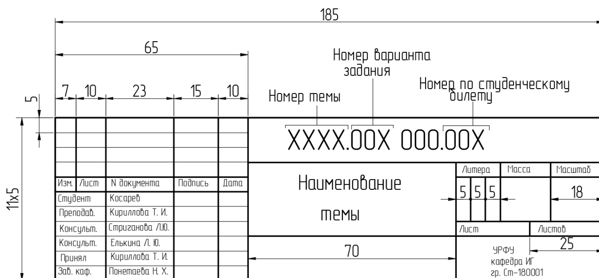
Рис. 64. Основная надпись форма 1 для чертежей основного комплекта документов
